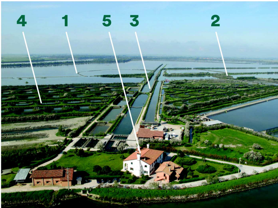
Una tipica Valle vista dall'alto, nella quale possiamo trovare: 1 - Grandi laghi per il pesce e le anatre da lago; 2 - Laghetti per la caccia; 3 - Vignua o Colauro principale; 4 - Peschiere; 5 - Casone
