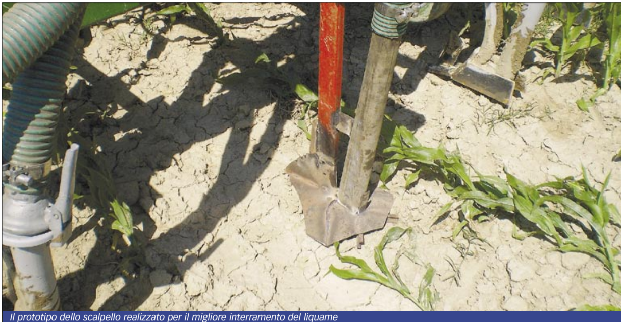
Il prototipo dello scalpello realizzato per il migliore interrimento del liquame
