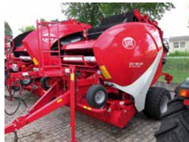
LELY WELGER RP 160 V CLASSIC rotopressa a camera e geometria variabile con infaldatore rotativo diametro palla da 80 a 160 cm 29.900,00 + iva
